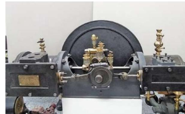
Conjunto máquina de vapor-compresor de la sulfitación de la Azucarera de San Isidro (Granada).
